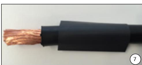
**(ill. 7)**Schrumpfschlauch auf Länge 47 mm
